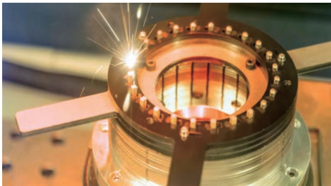
図1 電気モーターのヘアピン溶接(提供:トルンプ社)
