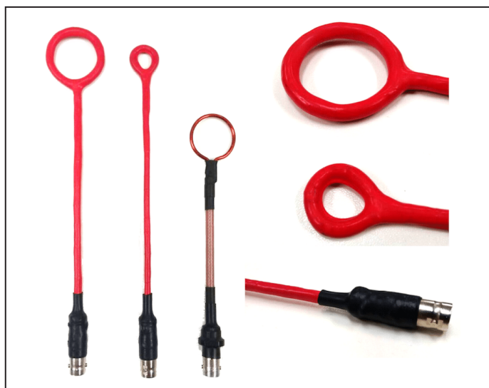
図1. 近磁界プローブ。右側が自作プローブを拡大したもの。
