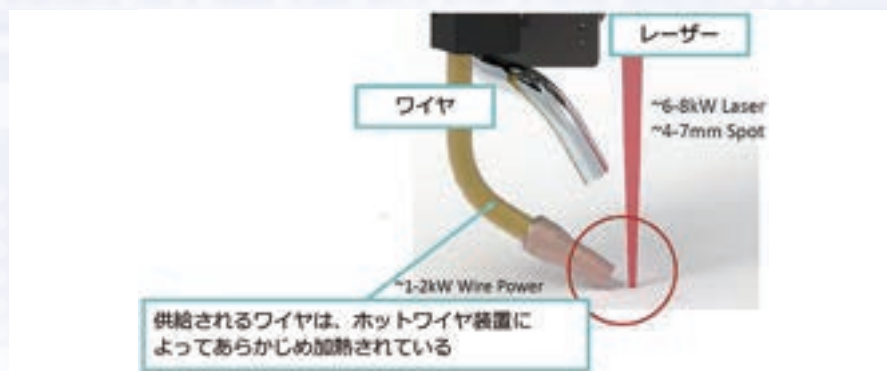
図2 レーザとホットワイヤによる小型溶接ヘッド(資料:Laserline社)
