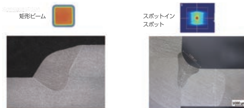
図4 加工用途に合わせたレーザービームの提案 (資料右:Laserline社、左エンシュウ)
