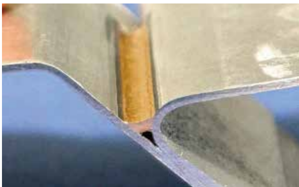
トリプルスポットによるろう付け 高品質な美しい継目を作ります。
