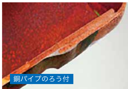
異材溶接（銅－鉄）断面
