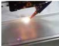
母材への熱影響を抑え、接合部分の後処理がほとんど不要な高品質な加工を高速で行う事が可能です。高い剛性と設計の自由度が求められる、自動車の車体構造物(ルーフ、トランク部分)等での世界中で豊富な実績や、各種産業分野への導入が盛んに進んでいます。
