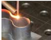
金属粉末をレーザービームにより溶融し、層ごとに積み重ねることで、金属積層造形が可能です。既存ワークへの追加工や、大型ワークの製造が可能となります。
