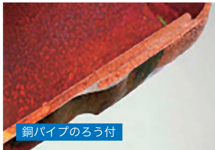
異材溶接 (銅-鉄) 断面
