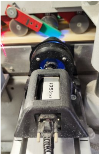
IDS NXT rio カメラが寄せ木張り層間の接着剤の接合不良を検出
