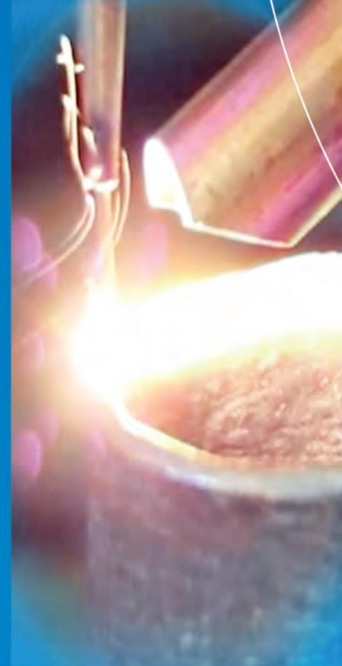
レーザーライン社の半導体レーザー装置を使用した**アディティブマニュファクチャリング (金属 3D 積層造形)**は、様々な分野で革新的な製造方法を生み出します。この方法により、同一材料（例：ステンレス鋼、アルミニウム、チタン、航空機製造向けの超合金材料など）での積層に、非常に効率的に適用することができます。結果として、従来必要とされた複雑な製造プロセスも、1台のレーザー光源をベースにした製造プロセスで現実化するのです。
