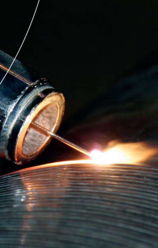
欠陥、割れ、剥離等、ダメージのあるコーティングは、最終的には高価となる可能性があります。レーザークラッディングでの補修は、高価な対象ワークを全く新しいワークと交換する必要がなくなります。
