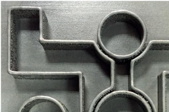
積層造形により構造体を構築できるため、複雑形状の 3 次元部品を実現します。
