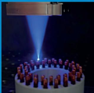
亜鉛めっき、溶融亜鉛めっき鋼板に関わらず、レーザーライン社の半導体レーザー装置は車体構造物用の**亜鉛めっき鋼板**の溶接にも使用できます。アルミニウム溶接と同様に、スポット・イン・スポットプロセスが使用されます。内外スポット間のレーザー出力配分を動的に最適化し、溶融池を滑らかにします。この方法で被加工物とレーザー光学系へのスパッタを最小限に抑え、クリーンで滑らかなシームになることが実証されています。
