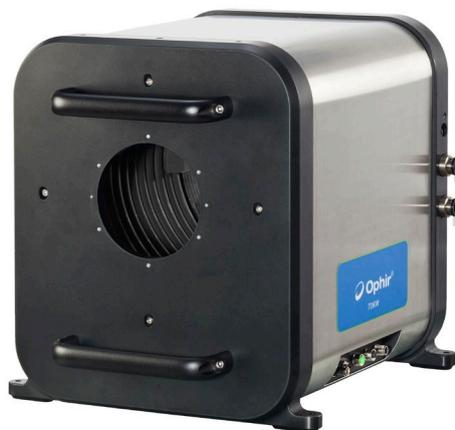
70K-W 超高出力センサーは柔軟性を重視して設計されており、冷却には水道水や脱イオン水（DI 水）の使用が可能です。また、垂直ビームおよび水平ビームにも対応しています。測定ユニットは Ethernet および RS232 インターフェースを備えており、アプリケーションのセットアップへのシームレスな対応が可能です。センサーは、ローカル電源供給または Ethernet 通信ポートを使用した Power Over Ethernet (POE) による電力供給が可能です。
