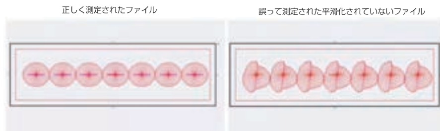
図1 42 Partners LimitedとLIAは、試験サービスプロバイダーとして、不正確な測光ファイルに起因して生じる可能性のある、数多くの誤りや厄介な問題を発見している。この図には、正しく測定されたLDTファイルが、試験誤差を含む平滑化されていないファイルと比較して示されている(本稿の図はすべてLIAと42 Partners Limitedが提供)
