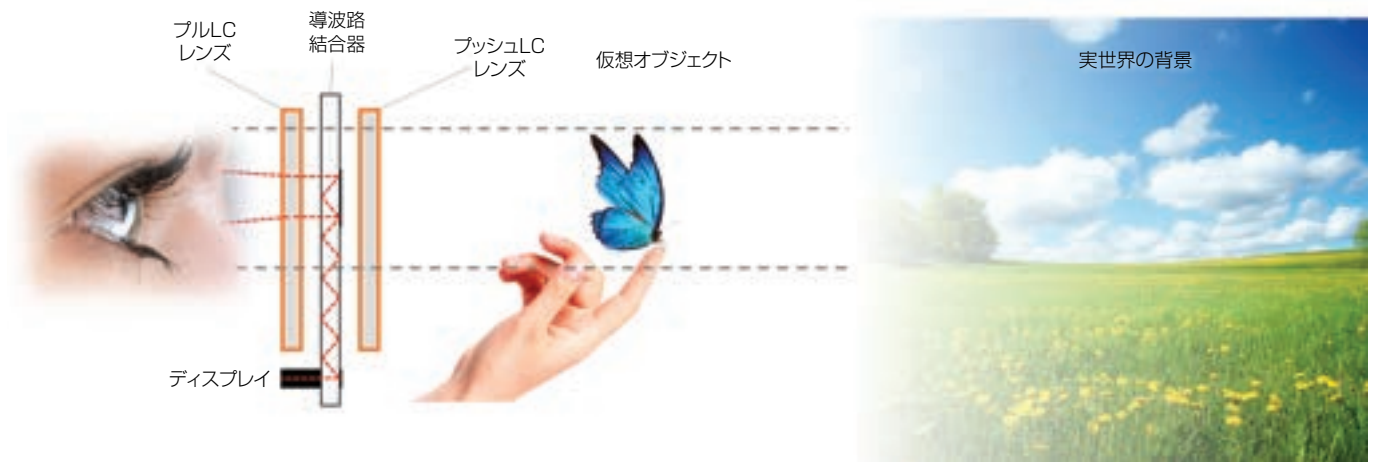
図4 シースルー型ARグラスにおけるプッシュブルの動作原理(画像提供:フレックスイネーブル社)
