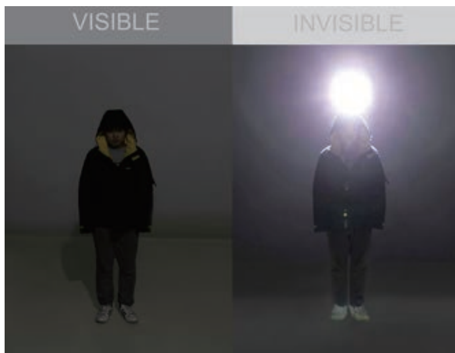
図2 減能グレアが視覚的コントラストに与える影響 (8) 。左の画像は、グレアが制御された照明状態を表しており、人物の顔が視認できる。右の画像では、グレアとコントラストの低下によって、同じ顔がぼやけて見える
