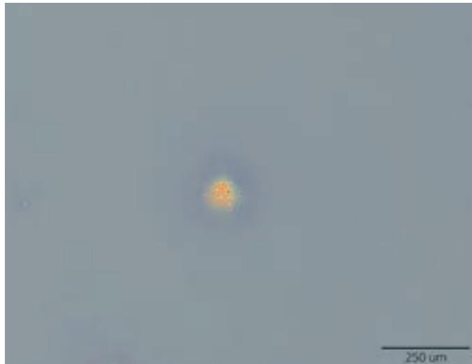
図2 ナノ秒パルスを出力する532nmのレーザーによるレーザー損傷。この損傷は、表面上のクレーターと再堆積した微粒子からわかるように、欠陥のクラスタによって引き起こされている (4)
