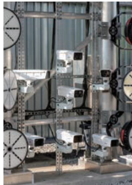
図3 カメラとレンズは、保護筐体の中に配置されて、スイングアームに設置されている
