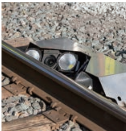
図2 カメラは、線路の高さに上向きに設置されているものなど、さまざまな角度で戦略的に配置されている
