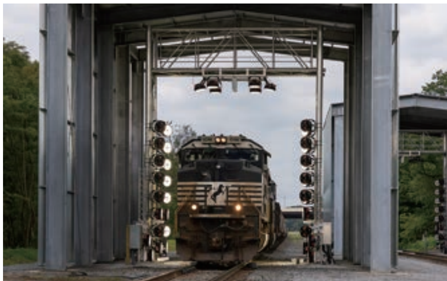
図1 列車検査ポータルは、高解像度カメラ、スタジアム照明、AIアルゴリズムを組み合わせて、最大毎時60マイルで走行する列車の画像を撮影し、解析する (本稿の図はすべてノーフォーク・サザン鉄道提供)
