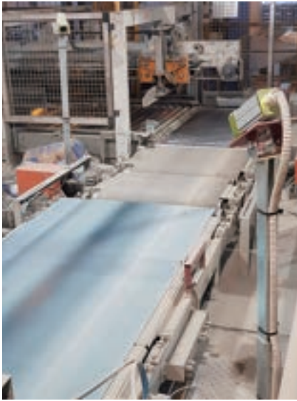
図2 生産ライン上に取り付けられた2台のカラーカメラは、セメント袋の裂け目、亀裂、漏れなどの欠陥を検査する
