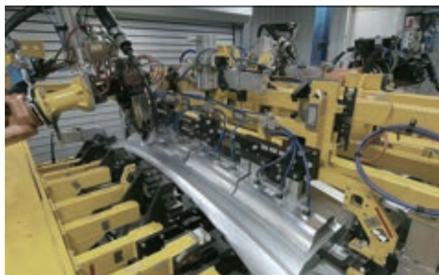
図3 レーザーブレイジングプロセスは完全に自動化されている。レーザーセル内に監視カメラが設置されているため、オペレーターはモニター上でその処理をたどることができる。それと同時に、レーザー光学系内部のカメラによって溶接が追跡され、すべてのデータがこの特定の車両に紐づけられる(写真の著作権は某メーカーに帰属)
