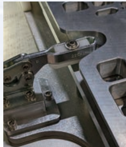
図3 パレット型の固定治具を固定するための標準的なレバークランプ。パレット型の固定治具は外部で組み立てられて、部品がプリロードされる
