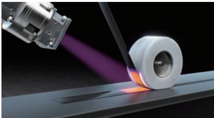
図 1 垂鉛めっき鋼板のレーザビーム遠隔溶接
