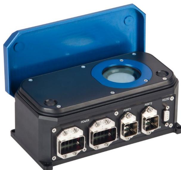
Helios Pro 産業用パワーメーターは、短いパルス（0.3 秒から数秒）のエネルギーと露出時間を測定し、その後出力を計算することで動作します。パルスエネルギーを 5kJ 以下に保つことで、水冷やファン冷却が不要となり、便利でコンパクトな設計を実現しています。Helios Pro メーターは測定中にパルス形状を監視し、遅いパルス立ち上がり時間が平均出力結果に与える影響を補正します。
