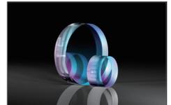
このミラーは、超短パルスのレーザー損傷閾値 (LDT) を最大化する革新的な設計アプローチを採用している。製品は 920nm のウルトラファストレーザー用に設計された薄膜コーティングとしては最高の LDT を持ち、920nm で 25fs のパルス時間に対して LDT は  $0.75\text{J}/\text{cm}^2$  を超える。これは、この波長とパルス時間向けに設計された市販品のミラーの LDT としては最高水準である。
