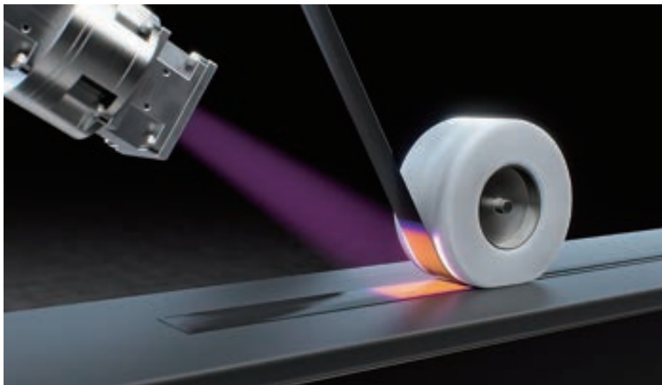
図1 均一な長方形ビームを用いたCFRPテープ自動配置
