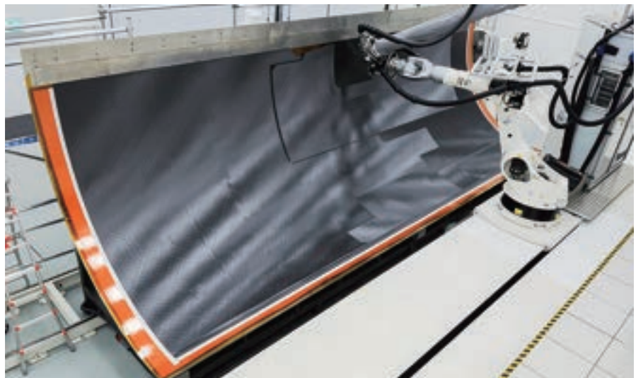
図3 巨大な航空機の胴体をオートクレープ外で製造
