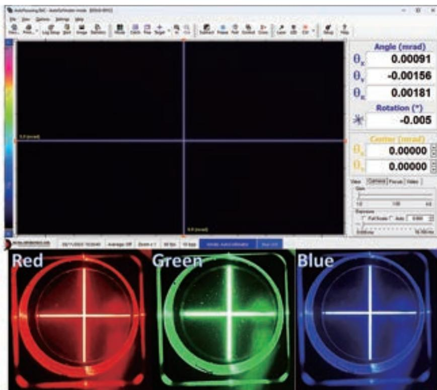
図2 RGB照明の切り替え機能は完璧にアライメントされており、使用するコーティングに関係なく、強力な後方反射を確保している。また、追加波長にも対応する(デューマ・オプトロニクス社提供)
