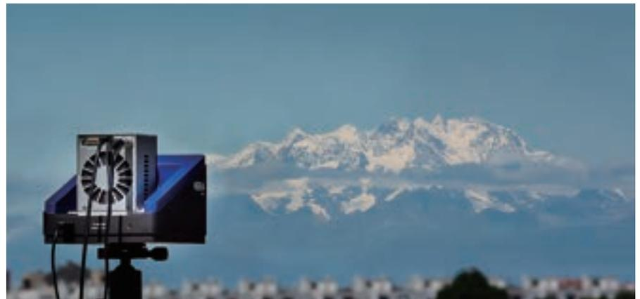
図2 ニレオス社製ハイパースペクトルカメラ「HERA eSWIR(1100-2200 nm)」(画像提供:ニレオス社)
