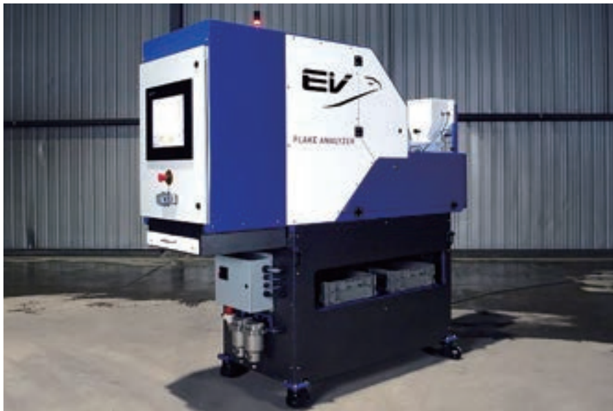
図1 「Flake Analyzer」は、さまざまなプラスチックポリマー、金属、紙を含む、30種類を超える材料を識別する(写真提供:イーグルビジョン社)
