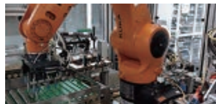
図1 ブラジルのクリティバにあるボッシュ社の工場では、産業用ロボットアームが、インジェクターノズルを取り上げて、プラットフォーム上に配置する。これによって、ノズルに刻印されたコードの画像をビジョンシステムで撮影することが可能になる(本稿写真はすべてゼブラ・テクノロジーズ社提供)
