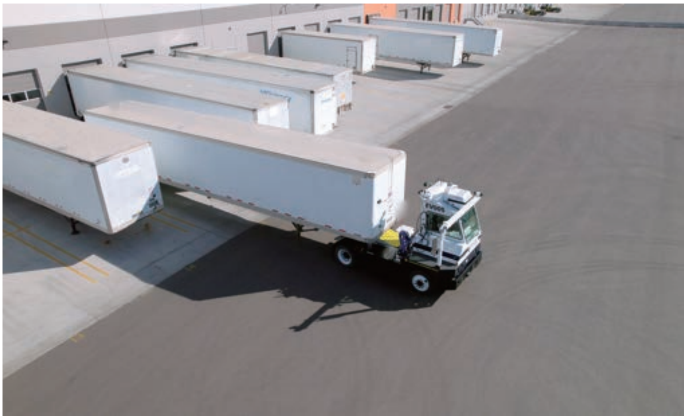
図1 AI支援の自律走行ヤードトラックが、バックでトレーラーを荷物搬入口に付ける様子(本稿写真はすべてアウトライダー社提供)
