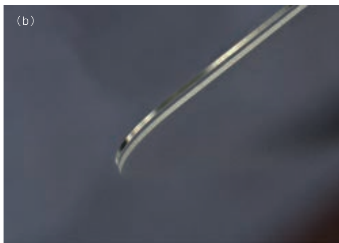
図1 (a)は、厚さ100 \mu\text{m} の超薄型ガラス (UTG) のサンプルの写真。ピコ秒パルスによって得られた粗い切断面 (右) と比べて、フェムト秒パルスを使用した場合の切断面 (左) は、非常にきめ細かく光沢のある仕上がりとなっている。(b)は、厚さ200 \mu\text{m} のUTGのサンプルの写真 (提供: フルーエンス社)
