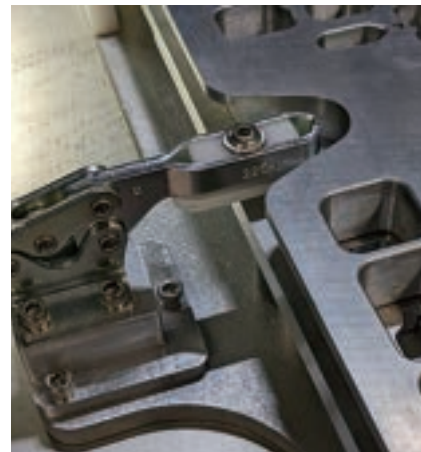
図3 パレット型の固定治具を固定するための標準的なレバークランプ。パレット型の固定治具は外部で組み立てられて、部品がプリロードされる
