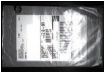
図8 偏光照明により、バーコードスキャナは、プラスチックフィルムを通して中身を読み取ることができる(提供: スマート・ビジョン・ライツ社)
