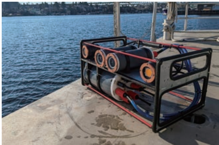
図2 マリンシツ社は、水中環境を監視するために長期間設置可能なAI支援のカメラシステムを開発した(写真提供:マリンシツ社)
