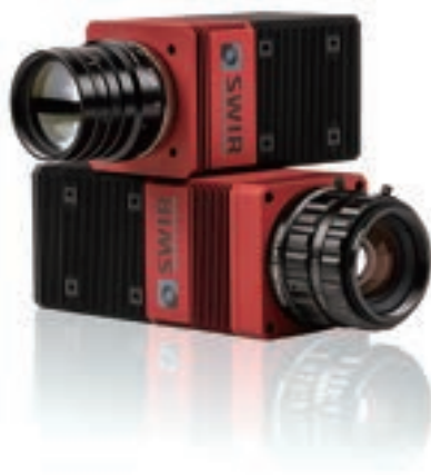
図7 SWIRビジョンシステムズ社のSWIRカメラ「Acuros」は、CQD-on-CMOSセンサを搭載し、可視域、近赤外域(NIR)、SWIR域のイメージングを行う(提供: SWIRビジョンシステムズ社)
