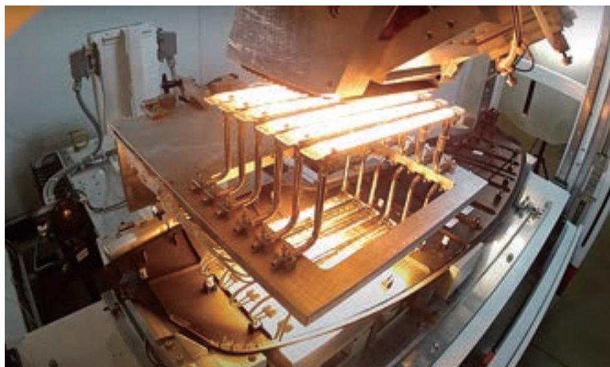
図2 赤外線ヒーターは、溶接する部品を素早く加熱して結合するために用いられる
