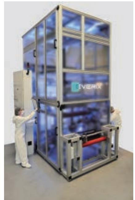
図2 エベリックス社のドロータワー(延伸タワー)は、光ファイバ製造施設で使われているものに似ている
