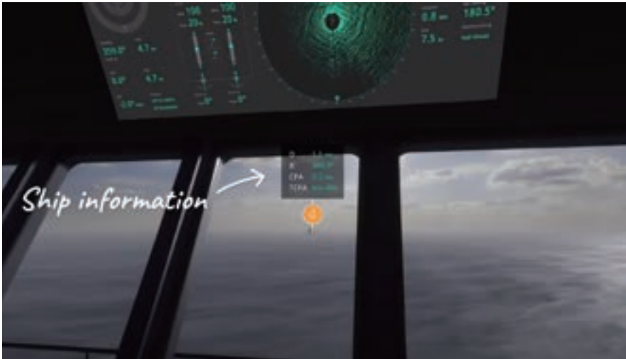
図4 船舶ブリッジに表示されたARナビゲーションの詳細情報を重ね合わせた図(画像提供: OICL)
