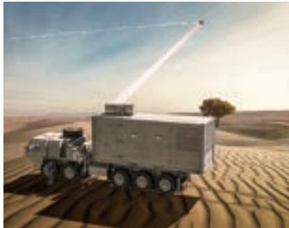
図2 米陸軍のIFPC-HEL (Indirect Fires Protection Capability-High Energy Laser)実証機の300kWレーザ兵器システム(写真提供:ロッキード・マーティン社)
