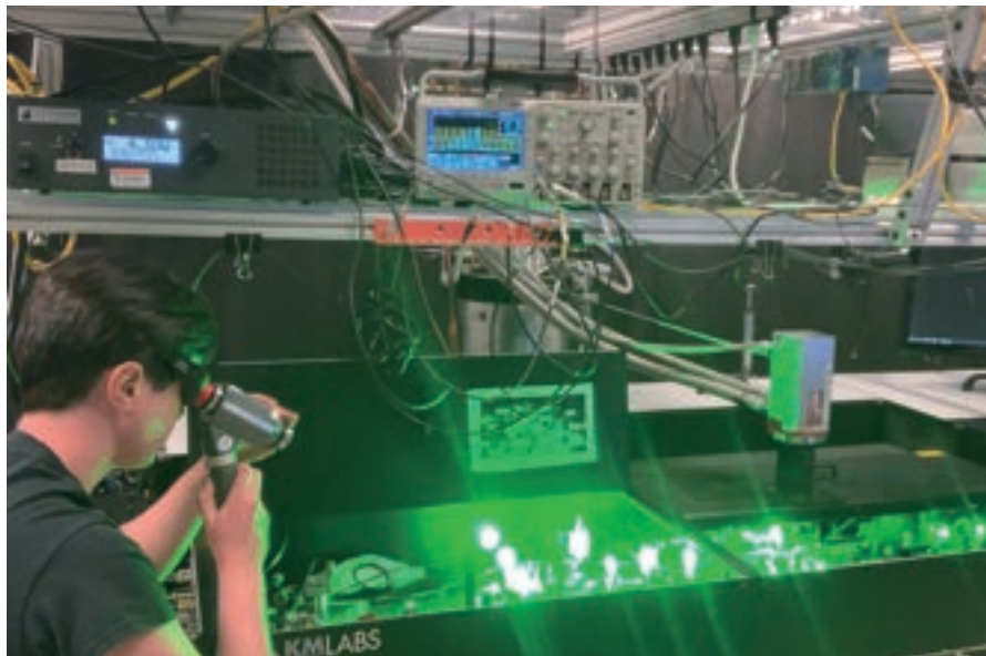
図4 増幅器での作業の様子。赤外線ビューアーでビームの位置を確認し、オシロスコープでレーザパルス測定する(写真提供:シニード・A・ライアン氏)
