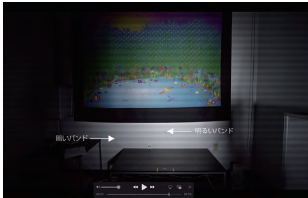
図3 PWMで照明を調光する際に現れた、暗いバンドと明るいバンド(画像提供:ペンシルベニア州立大)
