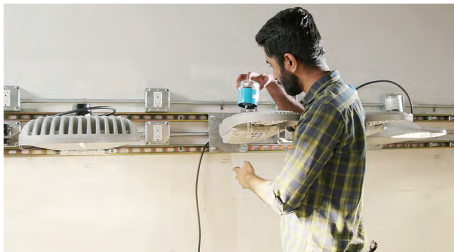
PNNLの研究者らは、屋外LED照明器具に接続された0~10V制御を評価した。さまざまな調光戦略を調査し、照明器具が無制御で最大定格電力で動作する場合と、0~10V制御信号による調光が行われる場合を基準として、それらの基準に照らし合わせて性能を分析した(画像提供:PNNL)
