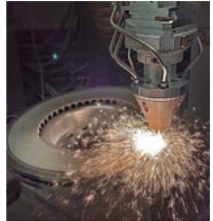
図2 ブレーキディスクのクラディング
