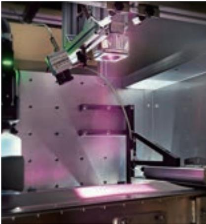
図1 赤外レーザーによる乾燥プロセス
