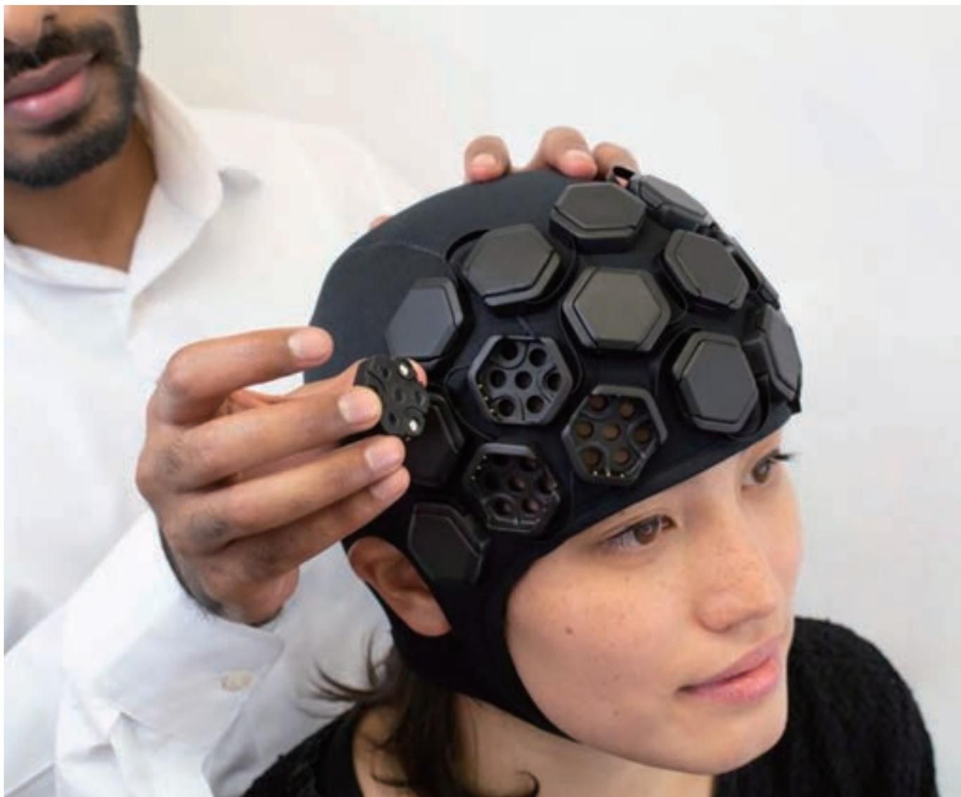
図1 研究者は、ウェアラブルでポータブルな高密度機能的 NIR イメージングデバイスである LUMO を使用する。このデバイスには、NIR 光源と検出器を内蔵したモジュール式タイルが備わっている (提供: ガウワラボ社)
