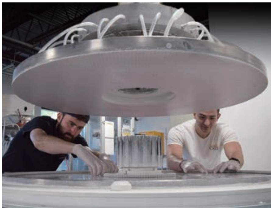
両面研磨機のウィンドウ列を検査するライアン・ヘガティ氏 (Ryan Hegarty、左) とステファン・ロング氏 (Stephen Long、右) (写真提供: エスコ・オプティクス社)
