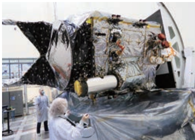
図4 NASAの小惑星探査機サイキに搭載されたDSOCフライトレーザー送受信機
