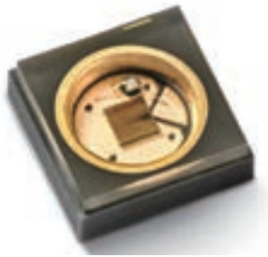
2016年のUV-C LED サイズ: 3.5 × 3.5mm 出力: 30mW WPE: 0.75%
