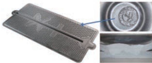
図5 バッテリー冷却プレート の溶接。小さな円 の溶接にガルバノスキャナ を使用する
