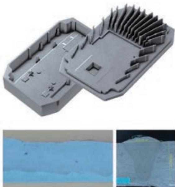
図6 ガルバノスキャナ によるアルミニウムダイキ ャスト熱交換器の溶接
