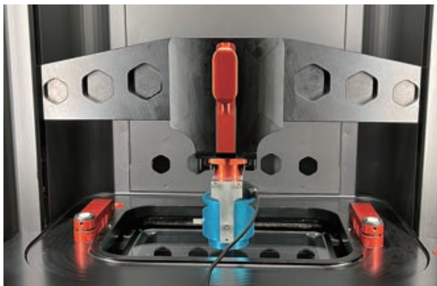
図2 レーザビームを測定するために、測定デバイスがブラケットによって取り付けられている
