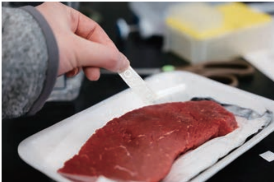
図3 このバイオセンサは、クロマトグラフィーなどの従来の検出方法で得られるのと同様の結果を生成する(提供: コンコルディア大のアディル・ボーカインド氏[Adil Boukind])
