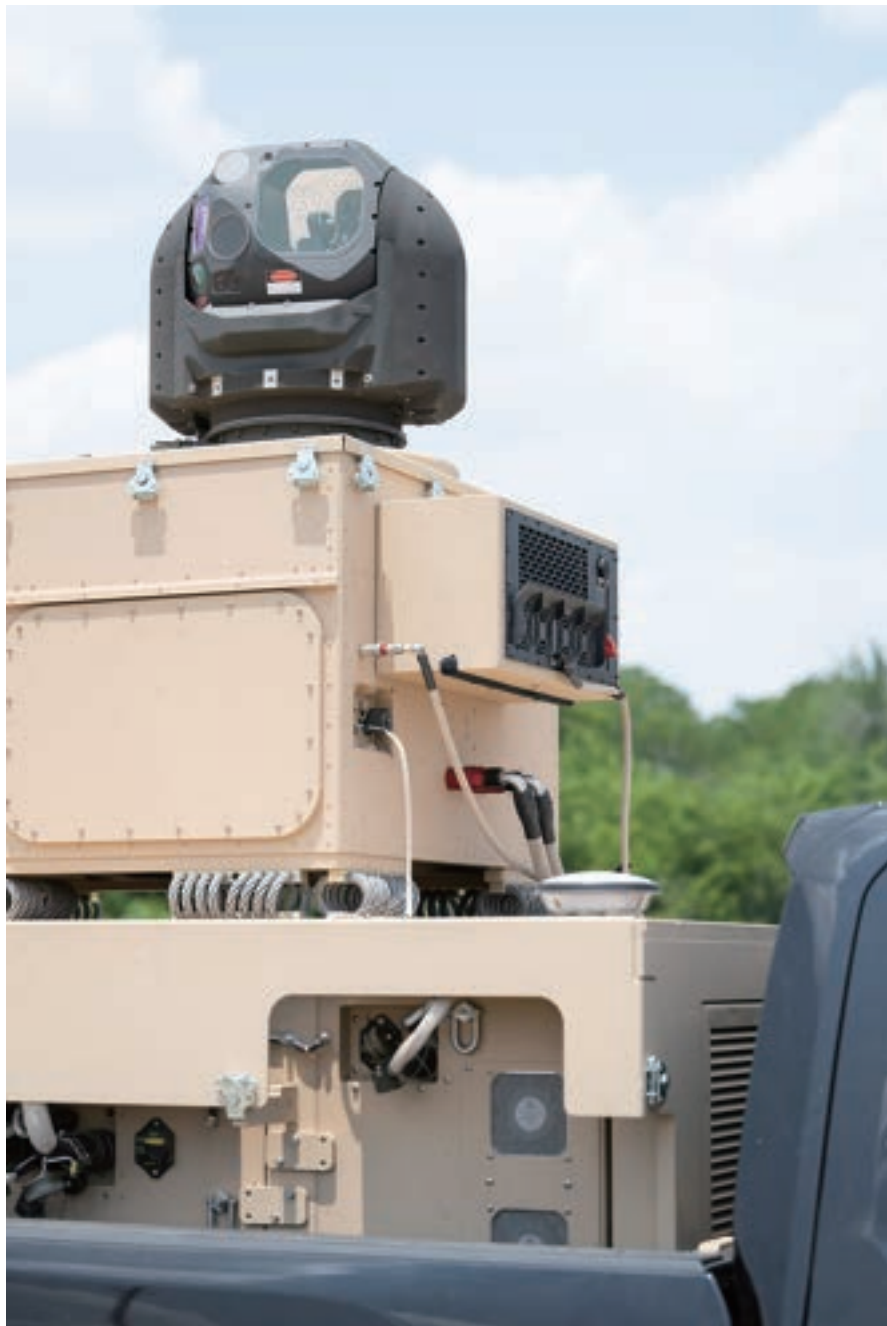
図1 米空軍の10kWのパレット式レーザー兵器「H4」(写真提供:レイセオン社)
