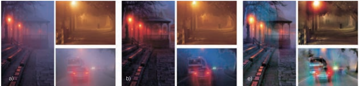
図2 ヘイズを含んだ画像(a)を、全体の光推定値によるダークチャンネル(b)、パッチベースの局所的な光推定値(c)で処理したもの
